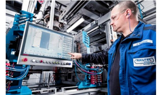
En plus des caractéristiques intrinsèques communes à la technique d'extrusion-soufflage, RIKUTEC utilise cette technologie multi couches pour adapter la fabrication des produits au domaine d'utilisation (par exemple la couche de polyéthylène alimentaire ou de couleur).
